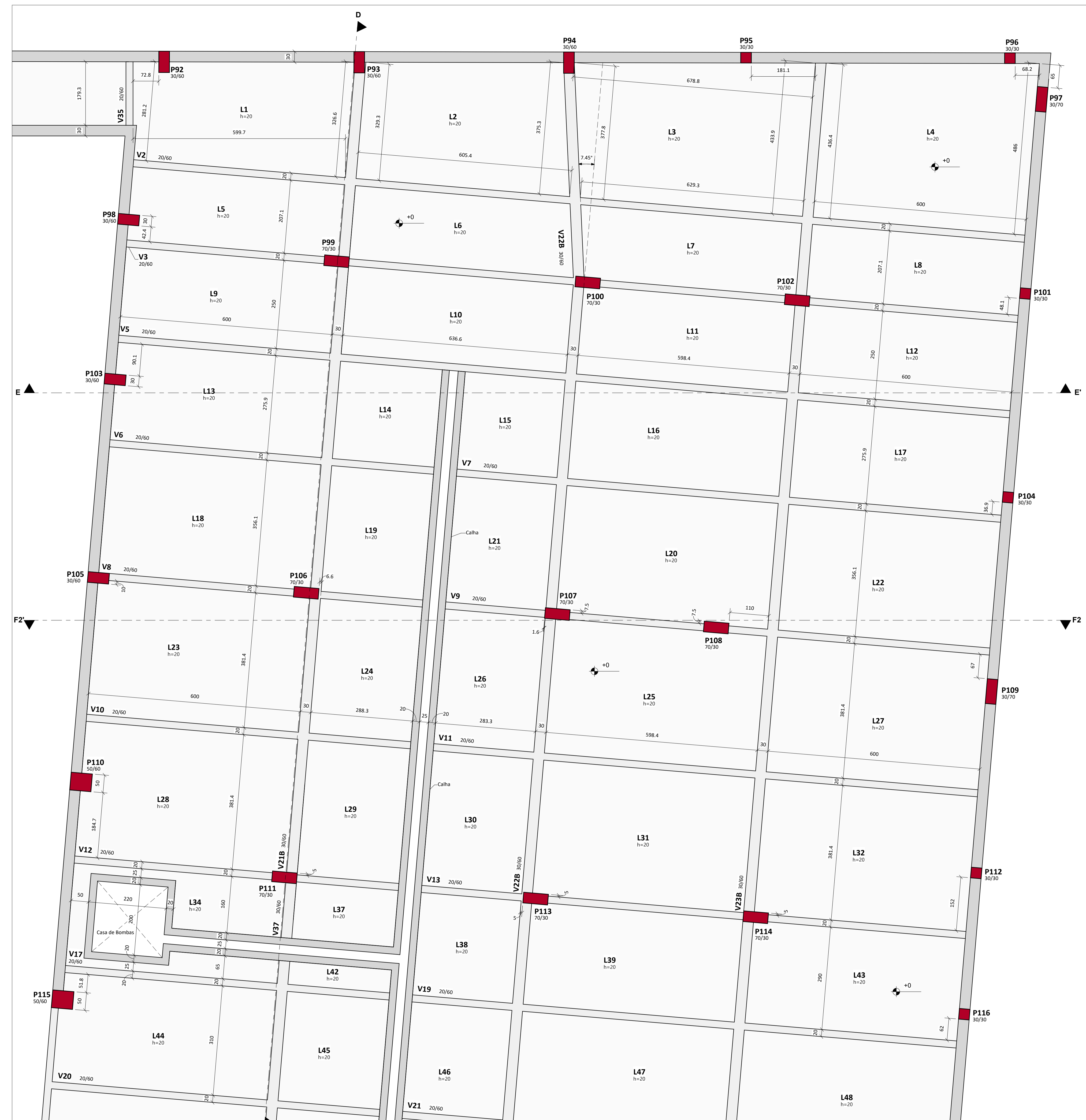
Forma do Pavimento: 00-Subsolo - J-1 Escala: 1 : 50
